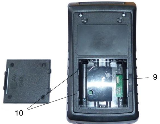
9 Akkuanschluss-Steckverbindung, 7polig
