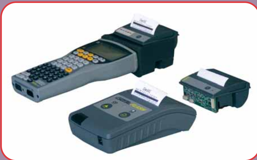
Bild 2. Der GPT-4352 verfügt über eine eigenständige Akkuladeschaltung
