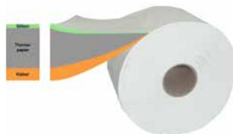
Abb. 2: Bei Linerless Papier wird Silikon auf die Thermoerschicht aufgebracht, um beim Aufrollen zur Papierrolle den Klebstoff auf der Unterseite von der Thermoerschicht zu trennen.
