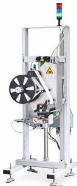
Abb. 3: Logopak Systeme Etikettiersystem Logomatic 400 Linerless mit GeBE Linerless Hochleistungsabschneider (Bild: Logopak)
